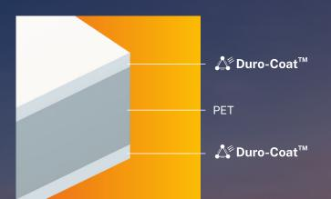
$Novanext^{TM}$ Duro-Sheet<sup>™</sup> Films Total Thickness: 275µm & 310µm
